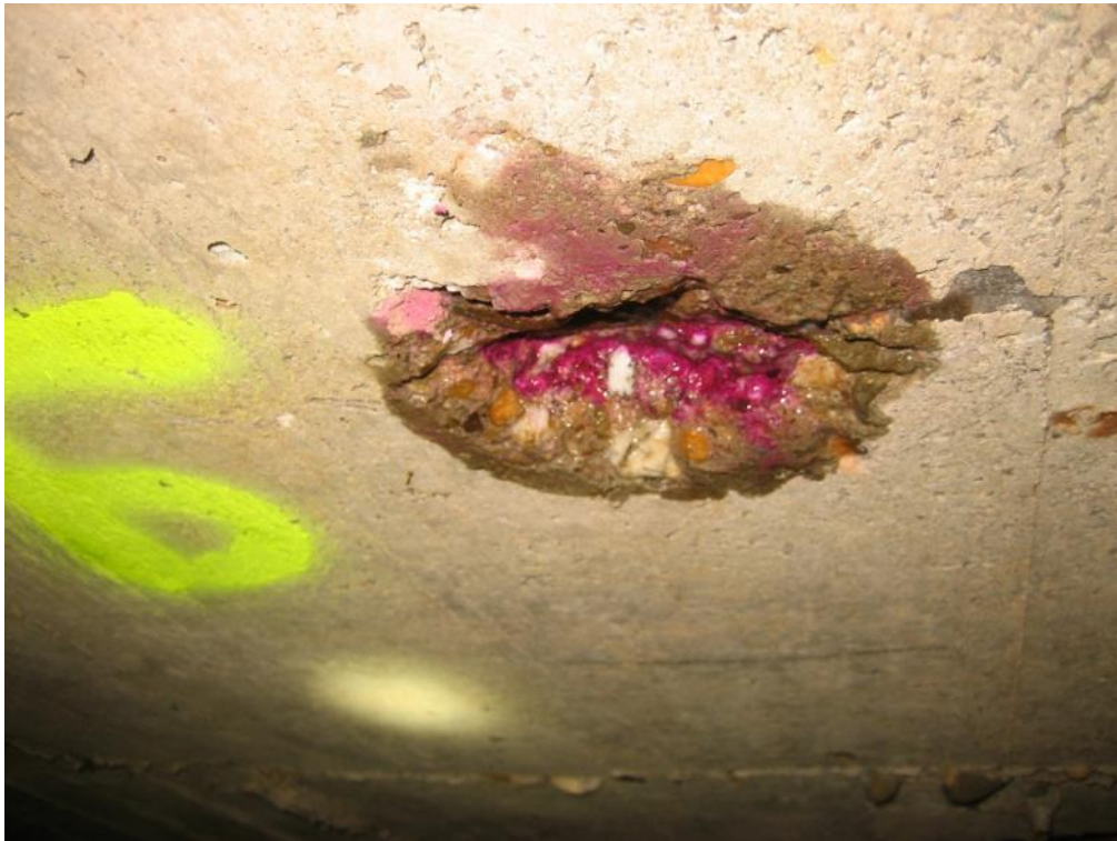
Abb. 46 Messung der Karbonatisierungstiefe
