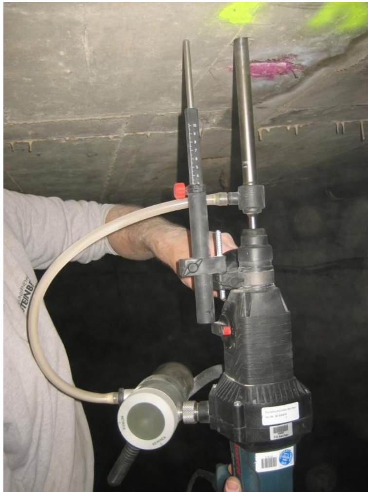
Abb. 14 Einsatz des Bohrmehlprobeentnahmegerätes
