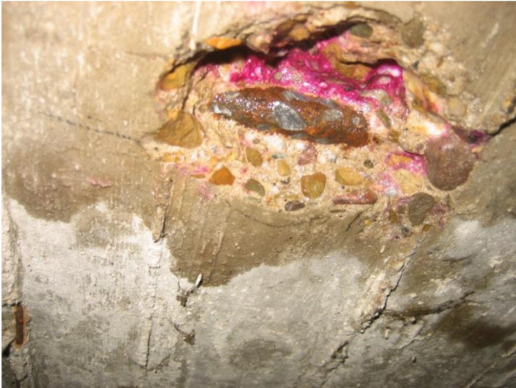
Abb. 47 Messung der Karbonatisierungstiefe
