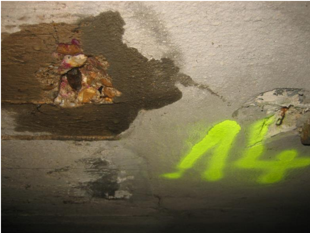
Abb. 48 Messung der Karbonatisierungstiefe
